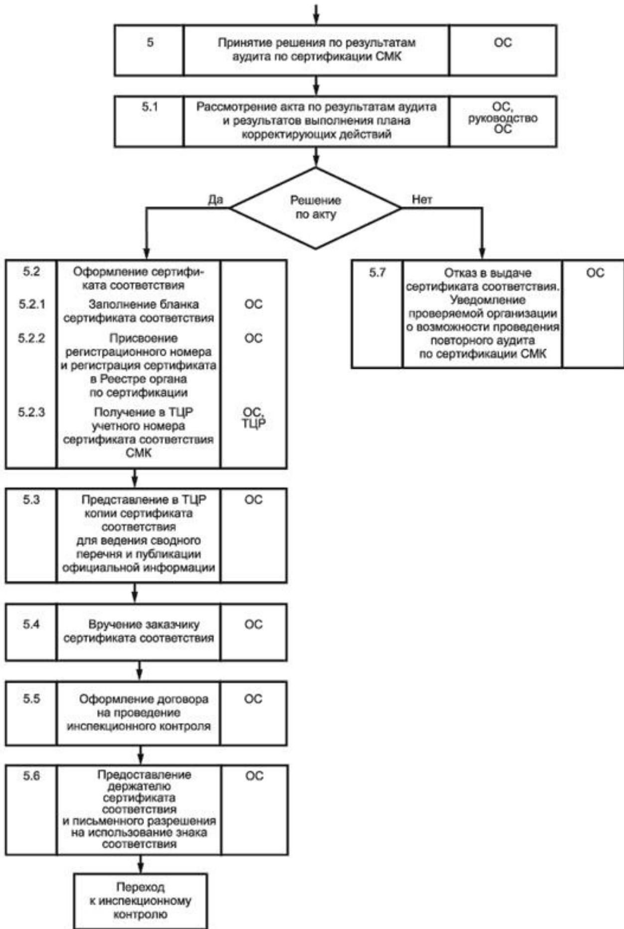
**Рисунок А.6 - Последовательность процедур инспекционного контроля сертифицированной системы менеджмента качества**
