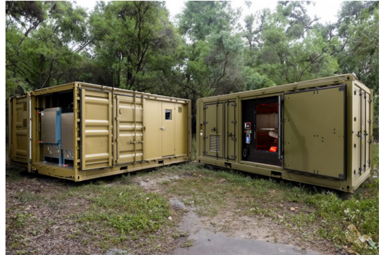
Рисунок 2. МОБИЛЬНАЯ КОНТЕЙНЕРНАЯ СИСТЕМА 3D-ПЕЧАТИ XSPEE3D 7
