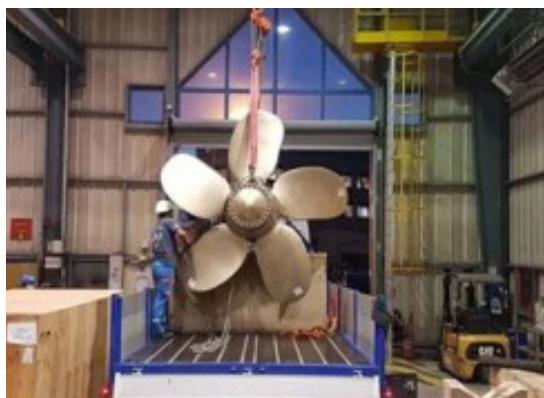
Рисунок 4. ГРЕБНОЙ ВИНТ, ИЗГОТОВЛЕННЫЙ МЕТОДОМ 3D-ПЕЧАТИ 10
